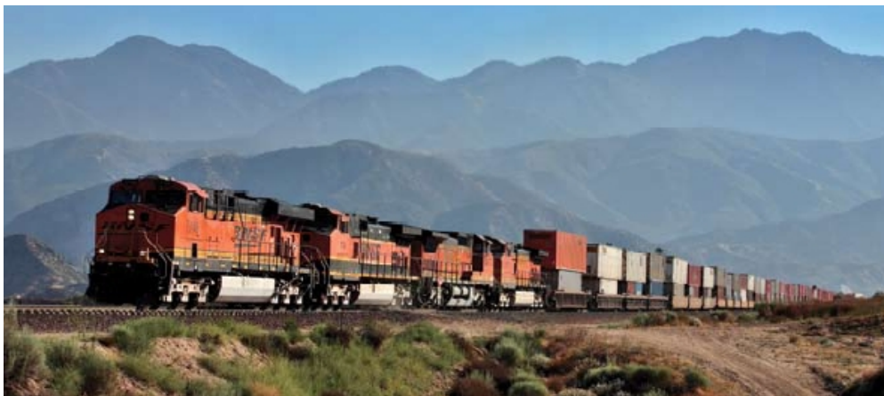
Figur 4.9 Amerikanskt containertåg med dubbelstaplade containers (BNSF)
