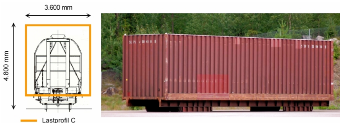
Figur 4.4 Lastprofil C jämfört med konventionell vagn (vänster) SECU-box (höger)
