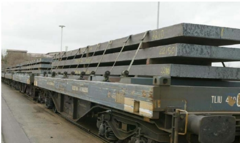
Figur 4.5 Slabs lastade på ett intermodalt flak vilket i sin tur är lastat på en järnvägsvagn (Outokumpu)
