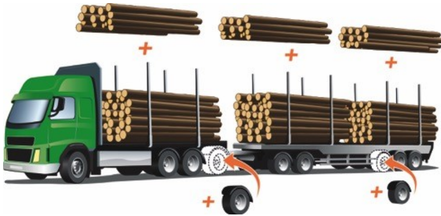
Figur 1. Exempel på 74-tonsfordon som får utnyttja den högre bärighetsklassen BK4. Illustration av Jorma Nautula med publicering tillåten av Skogsindustrierna.
