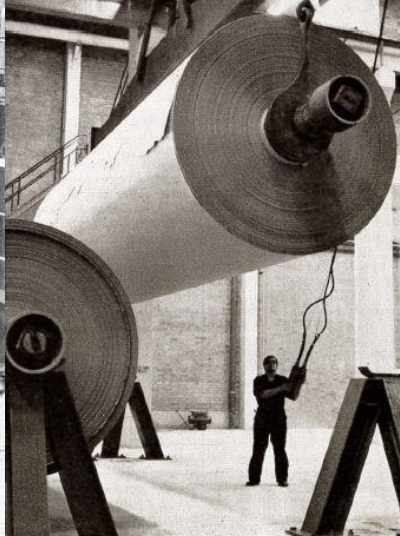
Som synes är pappersrullarna av avsevälig storlek. Den renskurna bredden är 6.600 mm. Rullhanteringen och packningen har planerats så att arbetet kan utföras under dagtid.
